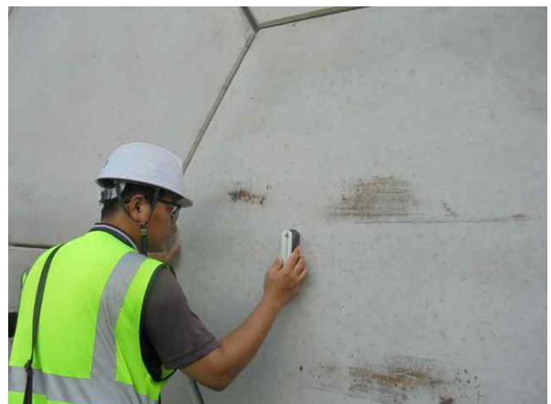
경사계를 이용한 경사도 측정
